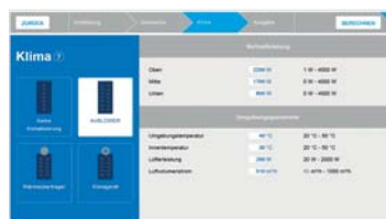
3. Schritt: Angaben zu Verlustleistung und Umgebungsparameter
