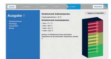
4. Schritt: Berechnung und differenzierte Darstellung der Schaltschrankinnentemperatur
