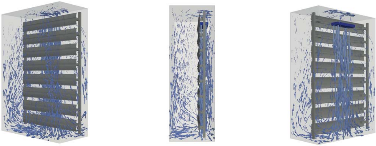
Abbildung 1: Zirkulationsströmung um AirSTREAM -Rahmen mit eingesetztem AirBLOWER -Lüftersystem
