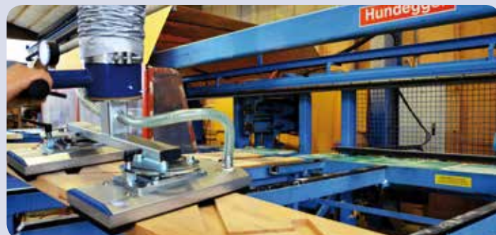
Schlauchheber mit Flächengreifer
