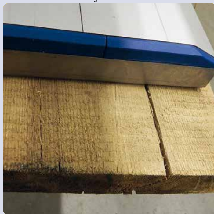
Heben von Holzbrettern mit Rissen oder Ausbrüchen
