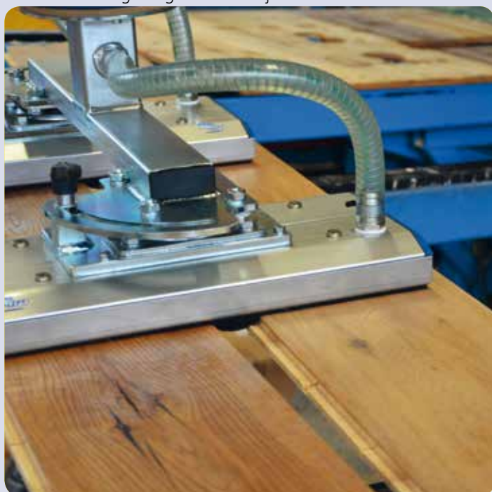
Heben von Holzbodensegmenten
