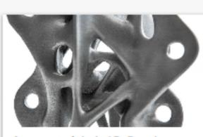
Arup entwickelt 3D-Druck Technik für Baustahl
