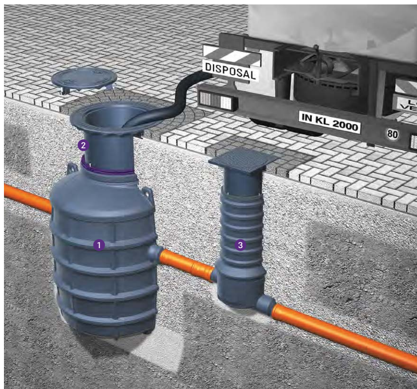
➊ Separatore di grassi ➋ Rialzo regolabile in altezza ➌ Pozzetto di prelievo
