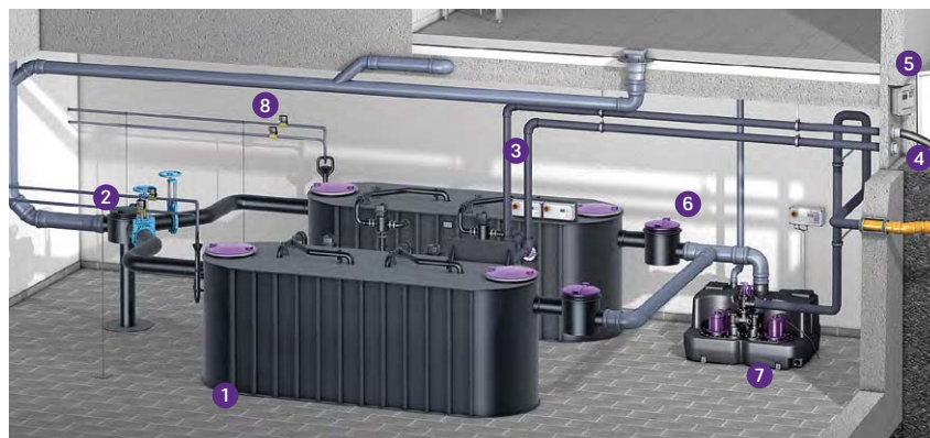
1 Separatore di grassi 2 Collettore di distribuzione 3 Linea di smaltimento 4 Collegamento per il camion di smaltimento 5 Sistema di telecomando (opzionale) 6 Pozzetto di prelievo 7 Stazione di sollevamento 8 Elettrovalvole
