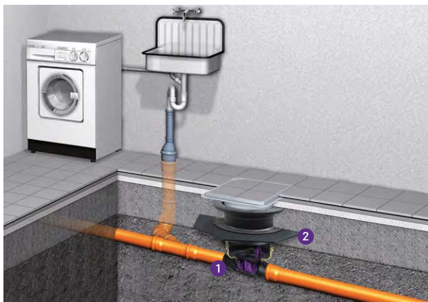
1 Valvola antiriflusso 2 Sezione di estensione
