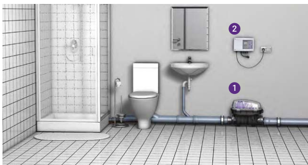
1 Impianto di pompaggio antiriflusso 2 Centralina
