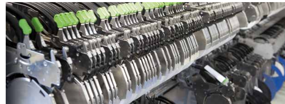
Bauteilfeeder in großer Stückzahl für besonders schnelle Rüstzeiten mit hoher Bauteildiversität Component Feeder in High Volumes for Short Set-up Time and High Component Mix
