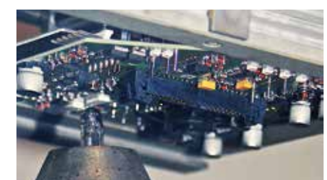
Selektivlötanlage mit Wechseltiegel Selective Solder System with Interchangeable Nozzles
