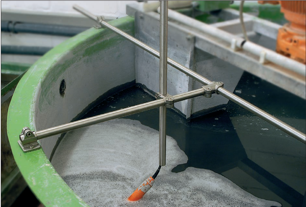
Einfache Sondenhalterung in agressiver Umgebung.
