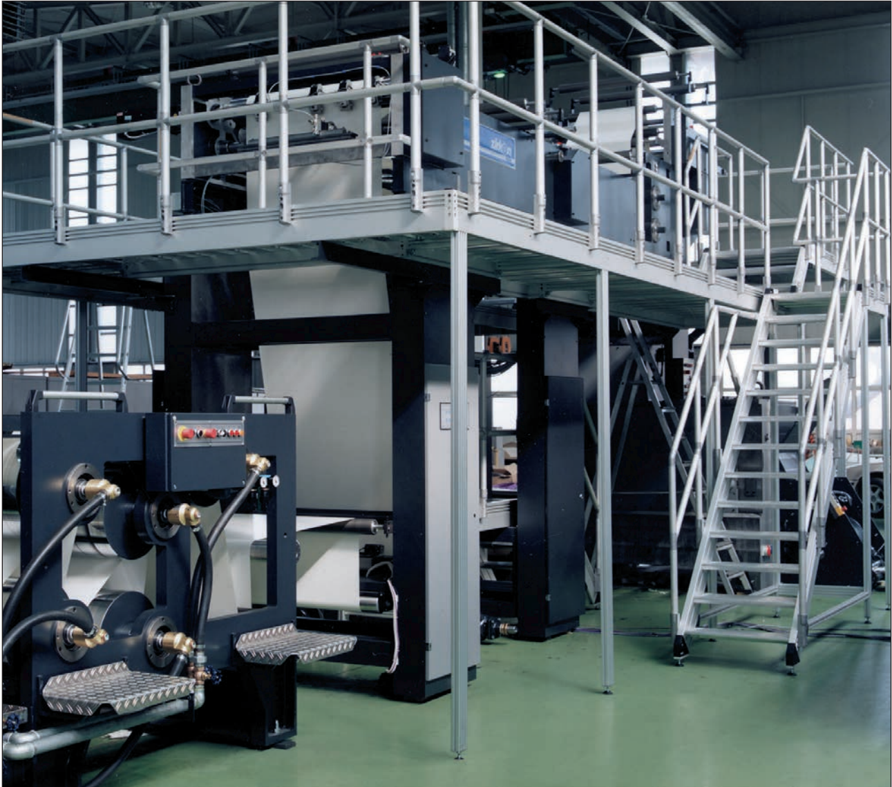
Arbeitsbühne mit Aufgang an einer Rollenoffset-Maschine.
