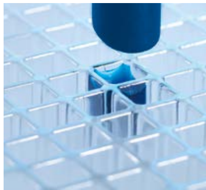
Die SoundPipe wird direkt über der Messstelle positioniert.
