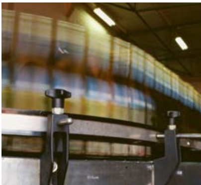
Der zws-7 mit 250 Hz Schaltfrequenz ist besonders für Zählaufgaben bei hohen Maschinengeschwindigkeiten geeignet.
