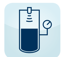
Füllstandmessung in 6 bar Überdruck
